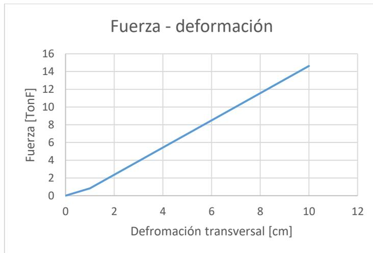
Figura B-8: Fuerza - deformación en barra anti-sísmica. Puente Chanco
