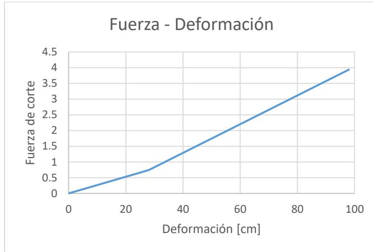
Figura B-7: Fuerza deformación en barra anti-sísmica. P.I Las Mercedes
