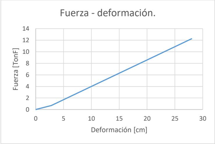
Figura B-9: Fuerza - deformación en barra sísmica. Puente Rarirruca
