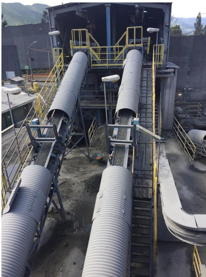
Figura 4-3. Encerramiento de correas transportadoras.
