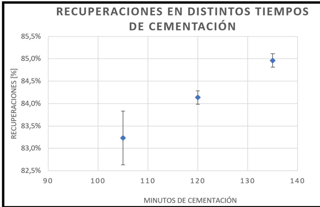
Figura 19: Cobre recuperado del proceso de cementación.
