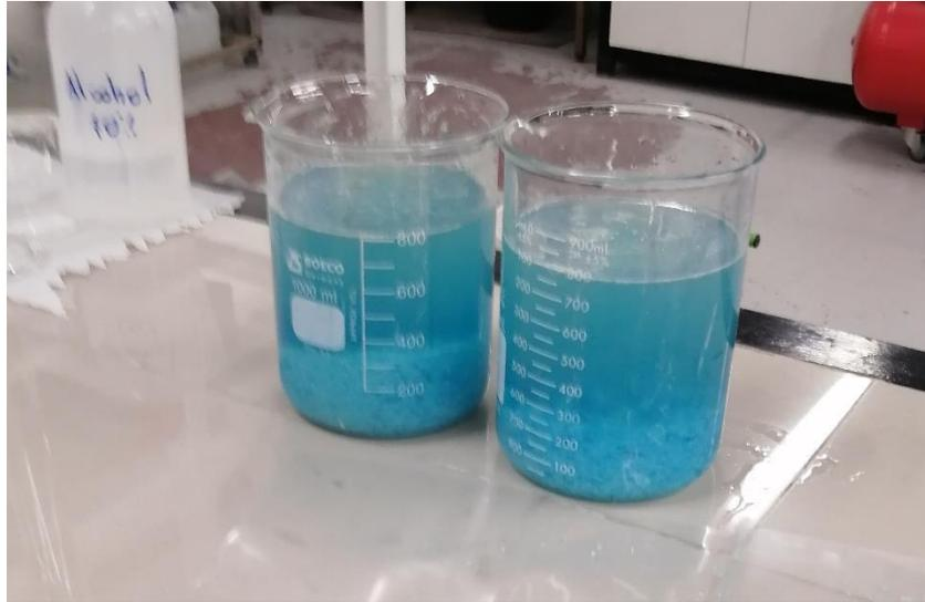
*Figura 12: Disolución de sal amoniacal en agua desmineralizada.*
