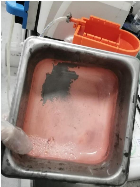
Figura 16: Cobre depositado en bandeja.
