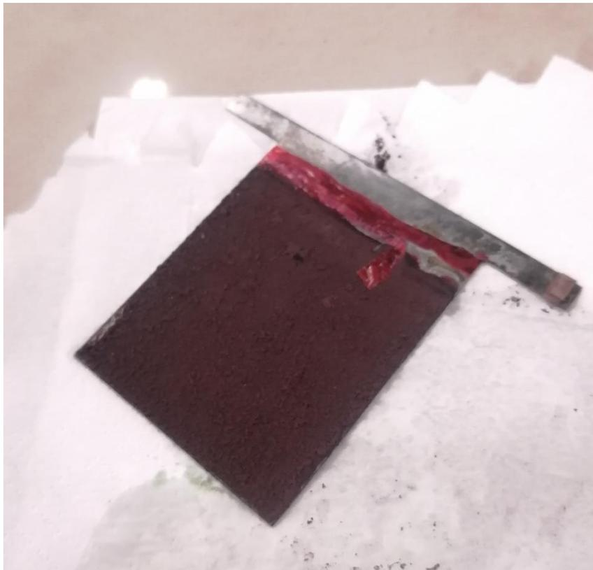
*Figura 17: Depósito de pasta en cátodo.*
