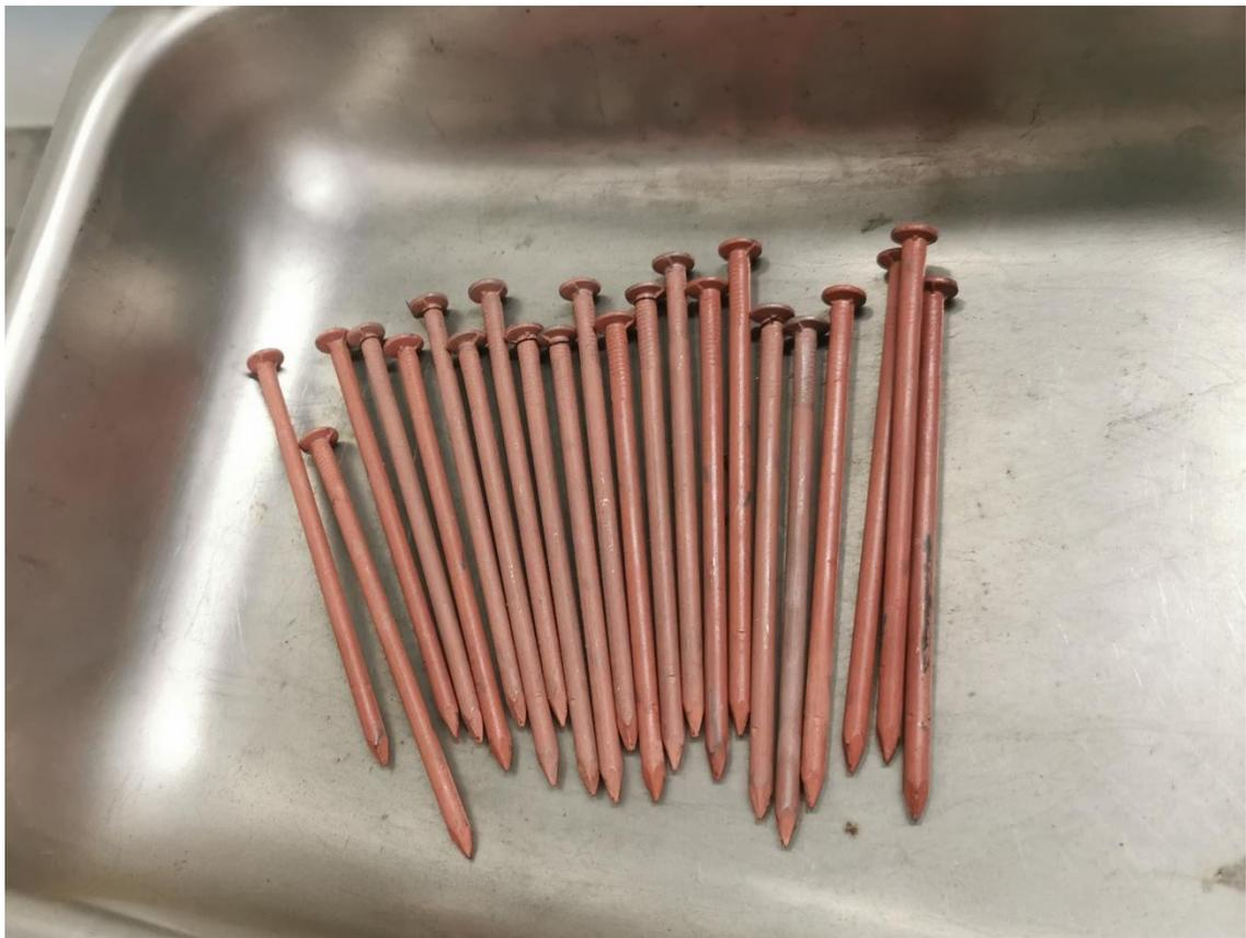
*Figura 18: Cobre cementado en clavos de hierro.*
