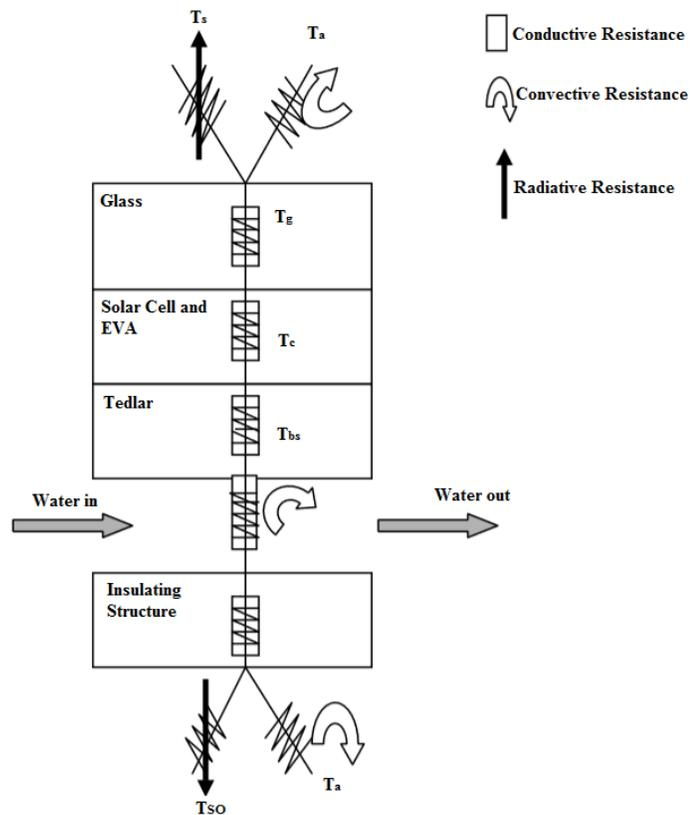
**Figura 3.7:** Diagrama de circuito de resistencia térmica para sistema fotovoltaico / térmico ([Tiwari y Sodha, 2006](#)).
