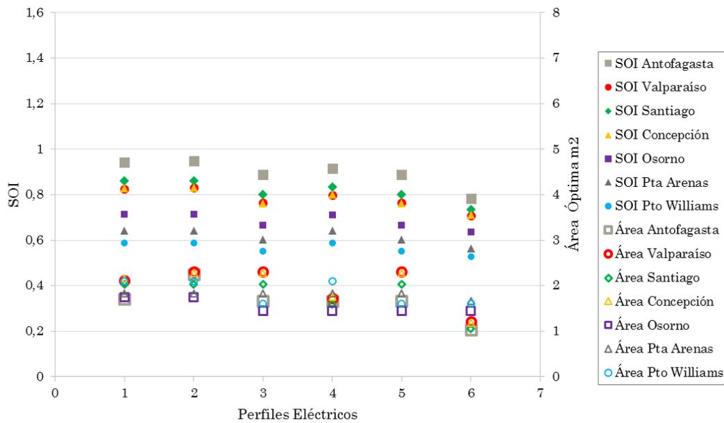
**Figura 5.14:** Evaluación del perfil 2 de ACS frente a los 6 perfiles de electricidad para obtener el SOI y el área óptima (Fuente: Elaboración propia).
