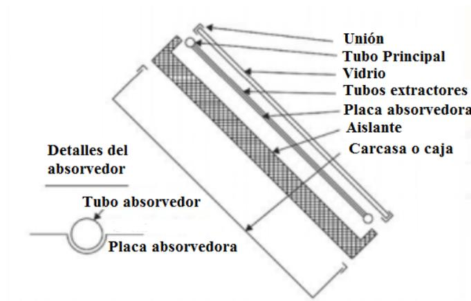
**Figura 3.2:** Sección Transversal de un colector solar plano ( Fuente: (Kalogirou, 2013) ).
