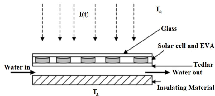
Figura 3.6: Vista transversal de un sistema fotovoltaico / térmico integrado (Tiwari y Sodha, 2006).
