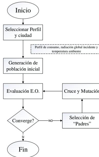
**Figura 4.4:** Representación esquemática del proceso de optimización (Fuente: (Araya Ibaceta, 2017)).
