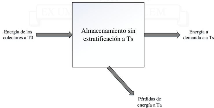
**Figura 3.9:** Almacenamiento sin estratificación de masa  $m_s$ , operando a la temperatura  $T_s$  dentro del ambiente a temperatura  $T_a$ . (Fuente: (Nacif Hartley et al., 2011))
