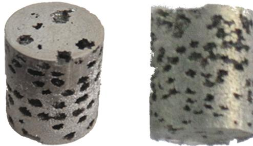
Figura 5.5: Espuma de Mg fabricada por pulvimetalurgia de espaciadores donde se observan características como porosidad abierta, presencia de poros en la superficie, aglomeración localizada e interconexión entre poros individuales
