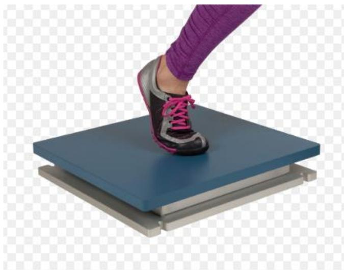
Figura 24: Esquema mediciones de fuerzas en la pisada.
