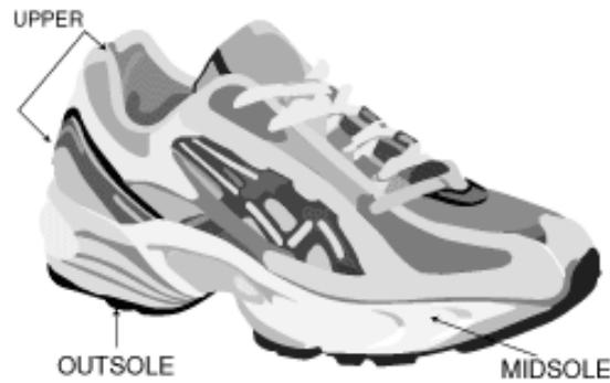
Figura 25: Partes de la suela de una zapatilla.
