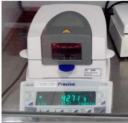
Figura 22: Equipo para medición de sólidos totales (Elaboración propia).
