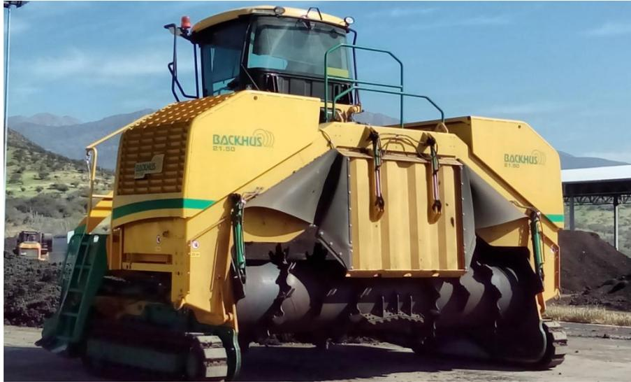
Figura 10: Máquina volteadora de los biosólidos (Elaboración propia).
