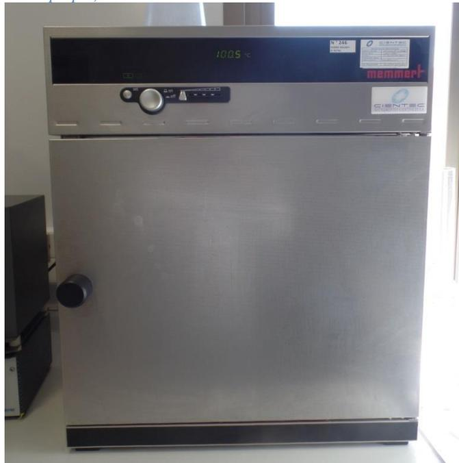
Figura 27: Estufa para medición de humedad (Elaboración propia).
