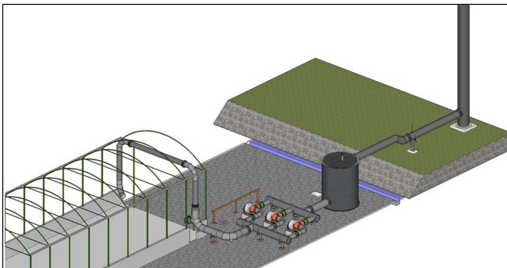
Figura 19: Vista general del invernadero y la conexión a extractores, lavador y chimenea. (PROAMCO, 2016)
