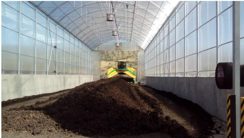
Figura 16: Vista interna del invernadero con biosólido (Elaboración propia).
