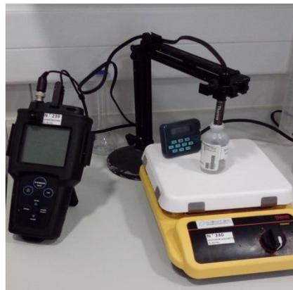
Figura 24: pH-metro para medir concentración de iones hidrógeno del biosólido (Elaboración propia).
