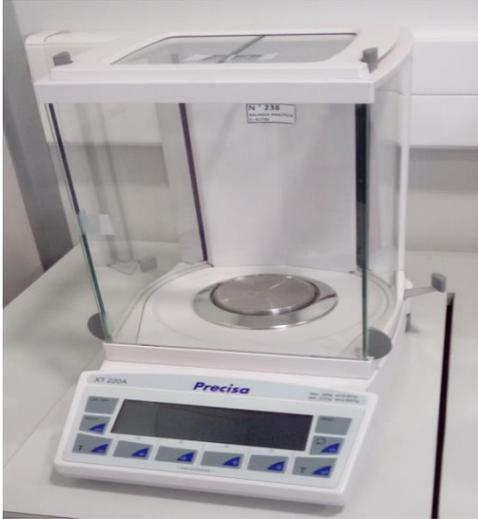
Figura 25: Balanza analítica para preparar muestras (Elaboración propia).
