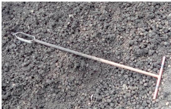
*Figura 21: Barreno para tomar muestra de biosólido (Elaboración propia).*
