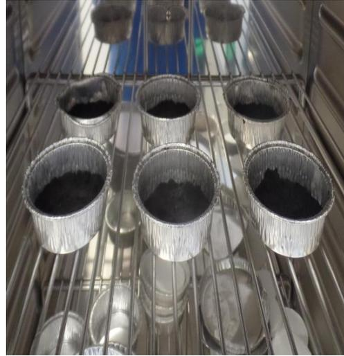
Figura 26: Muestras de biosólido en estufa (Elaboración propia).
