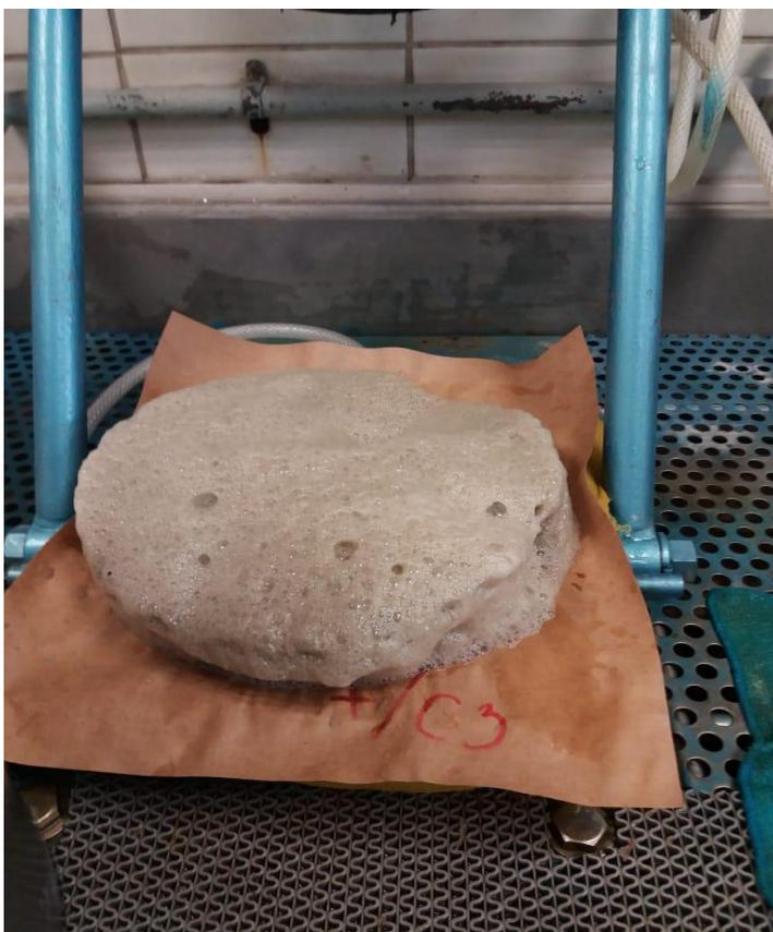
*Figura 18 concentrado de agua de desecho de cerveza listo para secado y posterior preparación de muestra*
