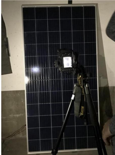
*Figura 6-22: Procedimiento de electroluminiscencia.*
