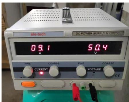
Figura 5-9: Fuente de poder ele-tech de 50 [V] y 20 [A].
