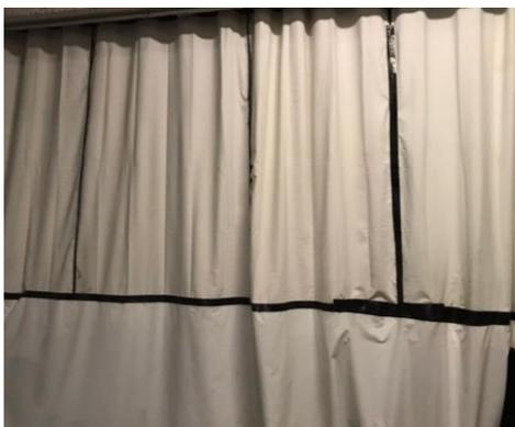
Figura 5-10: Pieza oscura para EL con cortinas blackout.
