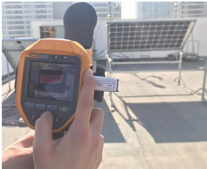
*Figura 6-9: Prueba de termografía bajo condiciones estacionarias.*
