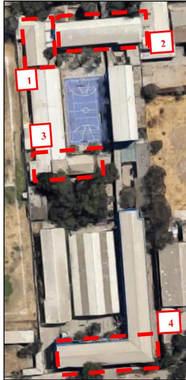
**Figura 3-12. Indicación de techumbres potencialmente útiles para instalar un sistema fotovoltaico. Fuente: Elaboración propia.**
