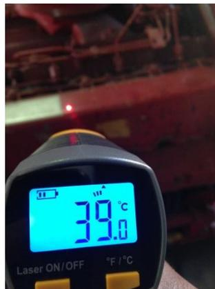
Figura 4 - 1 Termómetro a distancia midiendo temperatura de equipo.
