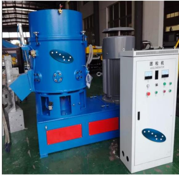
**Figura N°2.3 ilustración de máquina alglomeradora para plástico. Fuente: aglomerador de plástico/granulador de plástico, alibaba.**
