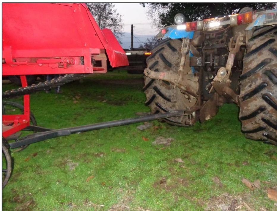
Esta es La forma en la cual se transporta el equipo a través del campo, esto es por medio de la lanza de la ensiladora, conectada al tercer punto del tractor
