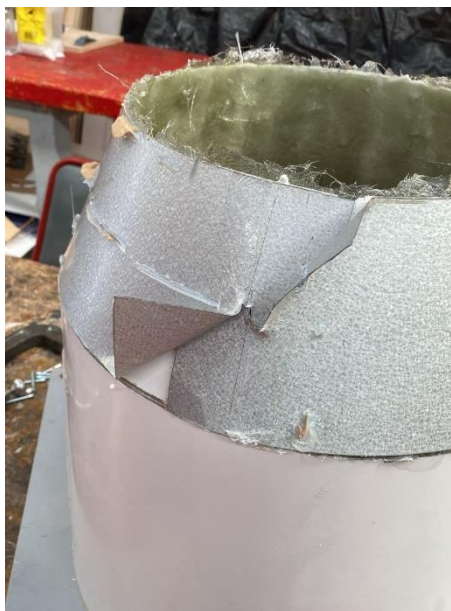
FIGURA 2-43. REGISTRO FOTOGRÁFICO DE DESMOLDEO DE CUADERNAS.
