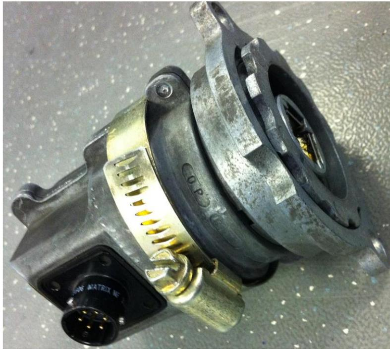
**Figura 12. Dispositivo Encoder. (Fuente: Metro de Santiago).**
