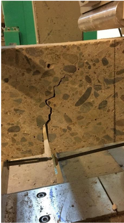
Ilustración 7.4 Posicionamiento LDVT y placa de vidrio
