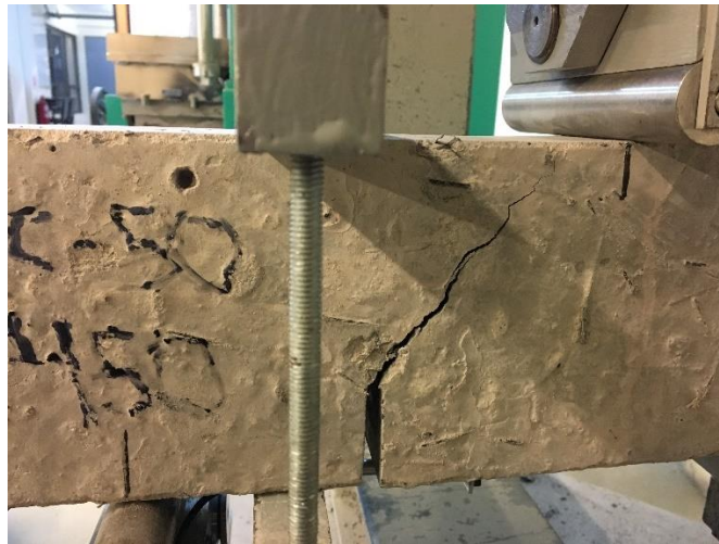
Ilustración 7.5 Grieta al terminar ensayo
