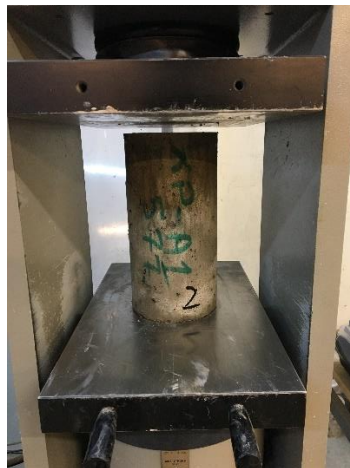
Ilustración 7.2 Posicionamiento ensayo compresión
