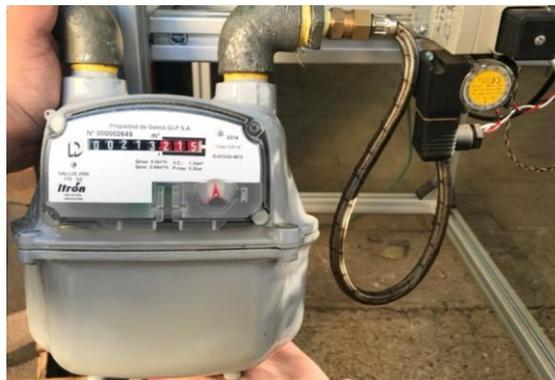
Figura 52: Instalación medidor de gas en el prototipo.
