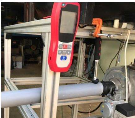
Figura 50: Instalación anemómetro entrada soplador de premezcla.
