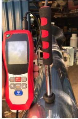
Figura 51: Instalación anemómetro a la salida del prototipo.
