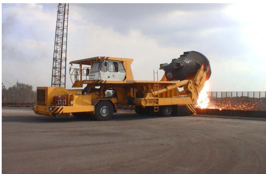
Figura 4-2: Camión Transportador de Escoria.
