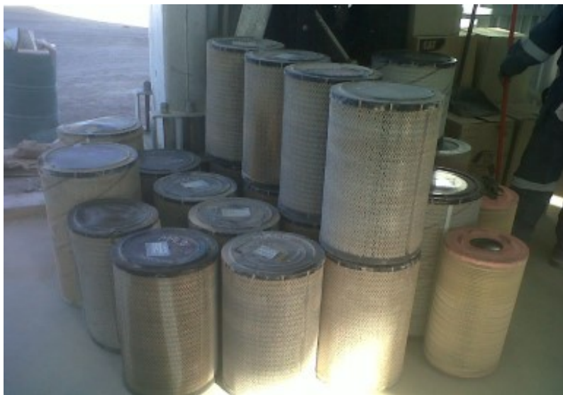
Figura 5.1: Filtros rotos luego de una entrega de una empresa que presta el servicio de limpieza de filtros de aire convencional.
