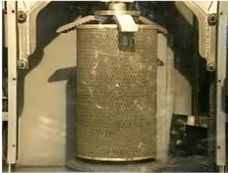
Figura 4.2: Filtro de aire en proceso de limpieza.
