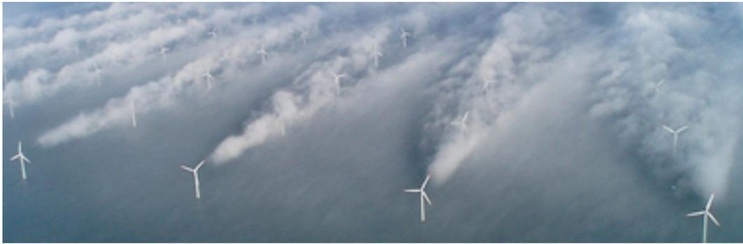
*Imagen 6-1 Nubes formándose en las estelas de los aerogeneradores en la planta eólica de Horns Rev, Dinamarca (Fuente: [www.windaction.org](http://www.windaction.org))*
