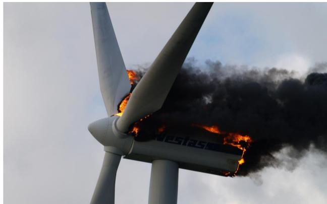
*Imagen 2-4 Aerogenerador en situación de incendio*
