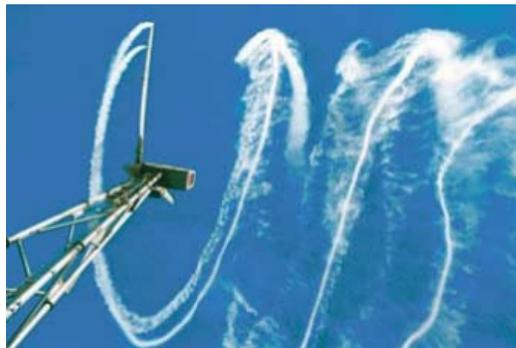
**Figura 3.28:** Ejemplo de Turbina provocando efecto estela
