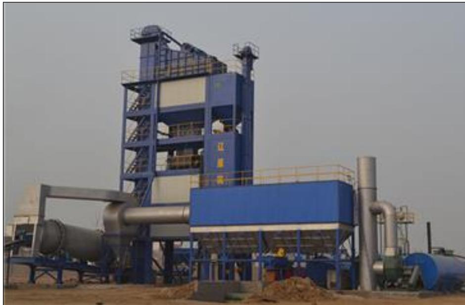
Figura E - 4 Planta asfáltica discontinua, Modelo LB4000, provisto por la empresa LYAOYUAN [31]
