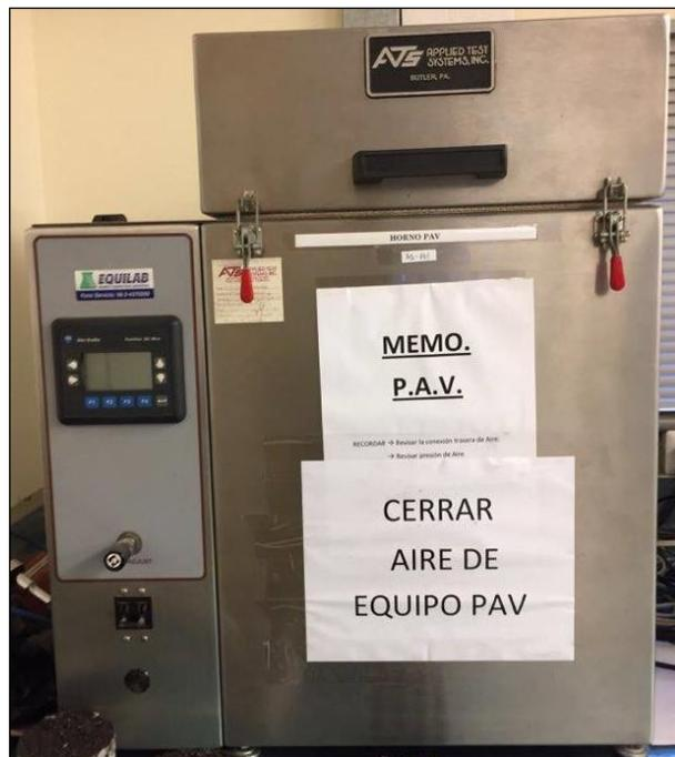
Foto A - 4 Cámara de envejecimiento acelerado
