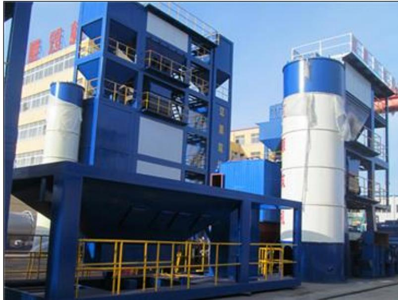
Figura E - 3 Planta asfáltica discontinua, Modelo LB4000, provisto por la empresa LYAOYUAN [31]
