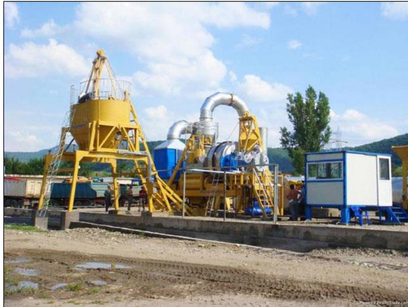
Figura E - 5 Planta asfáltica continua, Modelo SLB-8, provisto por la empresa LYAOYUAN [31]
