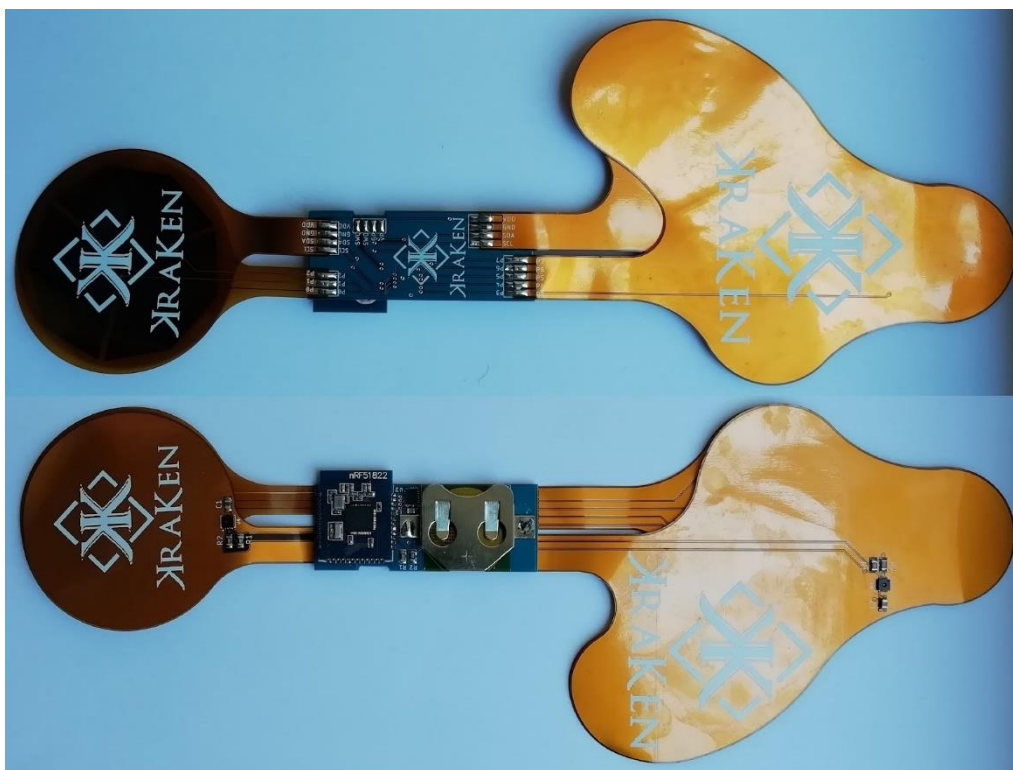
Ilustración 8: Etapa montaje y soldado finalizada. Fuente: Kraken SpA.
