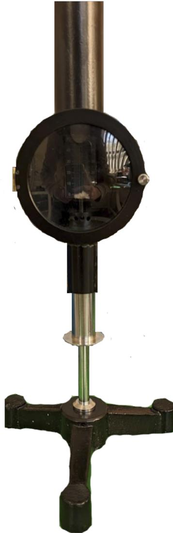
**Figura 3.18:** Lámpara estandarizada SYA-382 utilizada para las mediciones.
