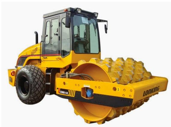
FIGURA 24: COMPACTADORA PATA DE CABRA.
