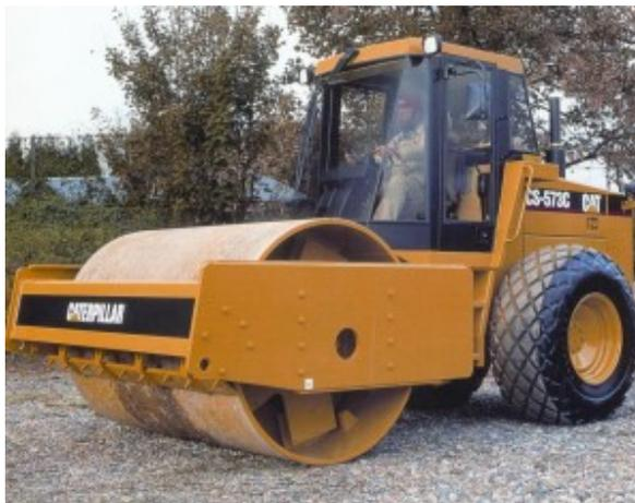
**FIGURA 22: COMPACTADORA DE RODILLO.**
