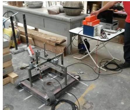
*Imagen 21: Instalación de computador y posterior conexión a LVDTs y celda de carga.*
