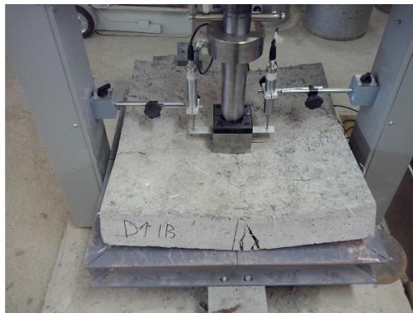
*Imagen 6: Ensayo de panel cuadrado EFNARC para determinar absorción de energía.*
