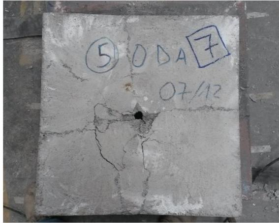
*Imagen 36: Panel con malla de acero galvanizado. Agrietamiento en cara superior.*
