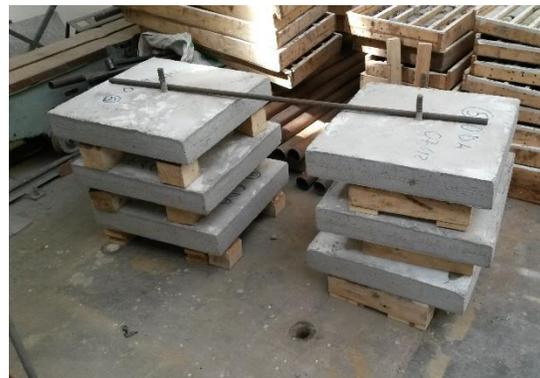
*Imagen 18: Paneles listos para ser ensayados.*
