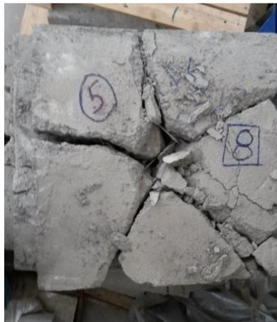
*Imagen 38: Panel con malla de acero galvanizado. Condiciones post ensayo.*
