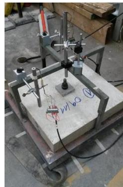
*Imagen 24: Ajuste de LVDTs sobre panel a ensayar.*
