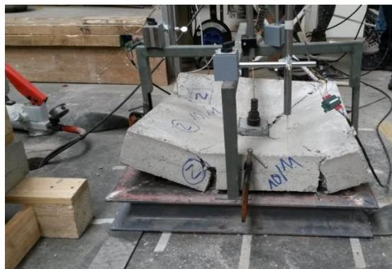
*Imagen 27: Panel deformado producto del ensayo.*
