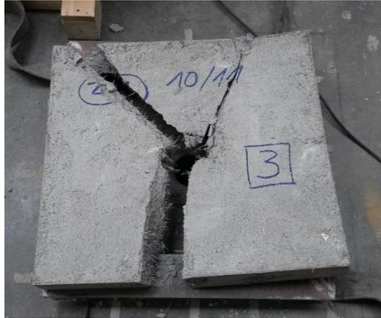
*Imagen 33: Panel con fibra sintética. Agrietamiento en cara superior.*
