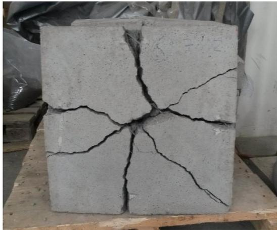
*Imagen 37: Panel con malla de acero galvanizado. Agrietamiento en cara inferior.*
