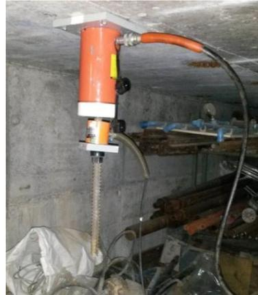
*Imagen 25: Conexión de gata hidráulica y celda de carga.*
