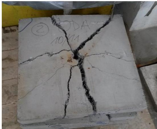
*Imagen 34: Panel con fibra sintética. Agrietamiento en cara inferior.*
