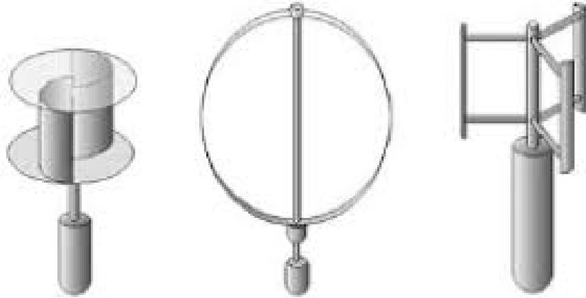
**Figura 2.9:** Ejemplos de Turbinas Verticales, Savonius (izquierda) y Darrieus (centro y derecha)
