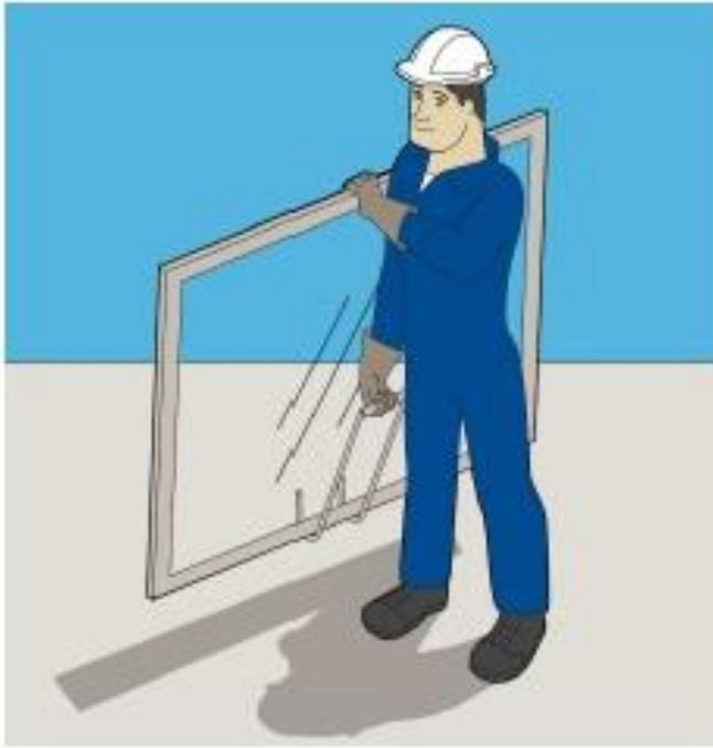
Figura 5-13: Sistema de sujeción para el transporte de materiales planos
