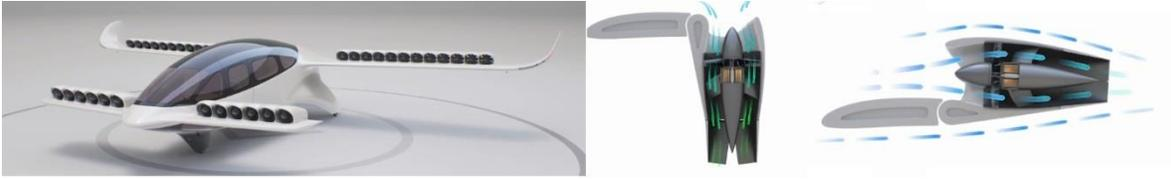
*Imagen 4: Imágenes referenciales a la aeronave eVTOL Lilium Jet y el funcionamiento de los motores en momento su aterrizaje o despegue y en momento de vuelo crucero respectivamente (Lilium, 2021).*
