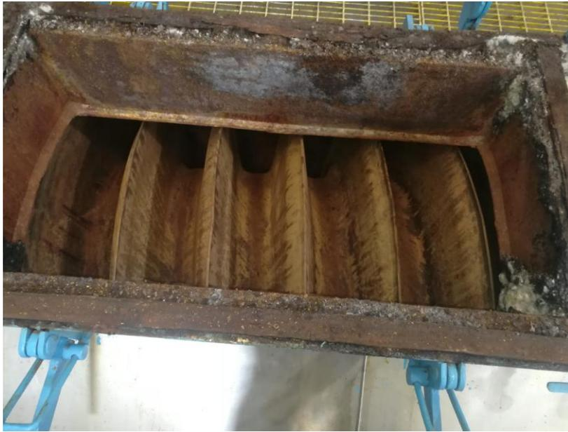
Figura 2-13: Tornillo Helicoidal
