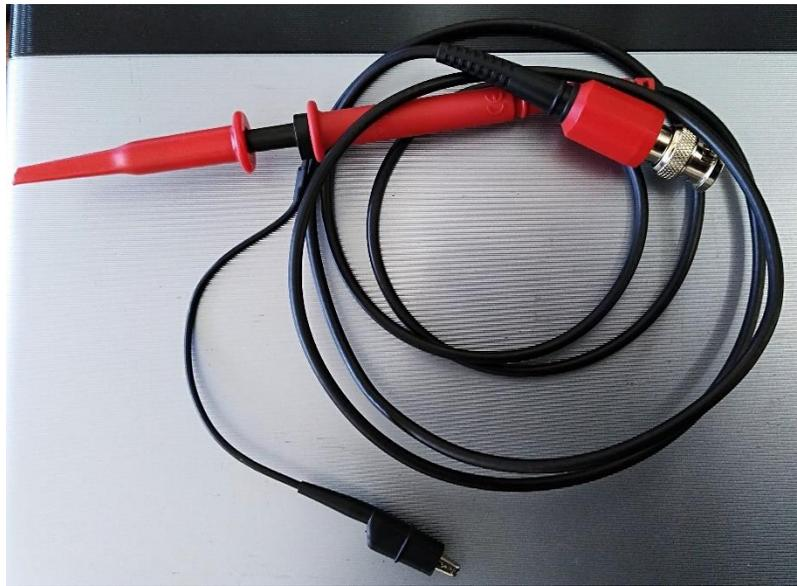
Figura 2-22. Sonda para Osciloscopio GE3121 serie 2kv 100MHz.
