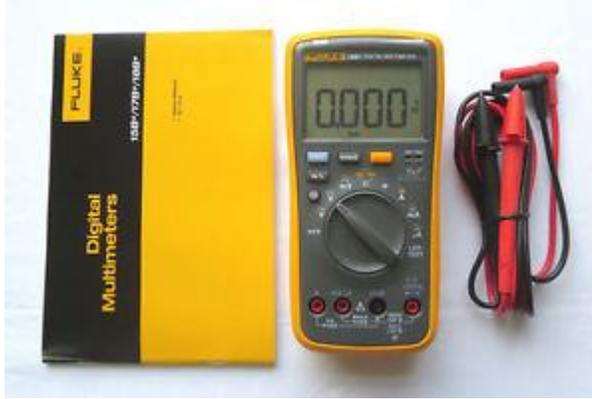
Figura 2-17. Multímetro FLUKE 15B.
