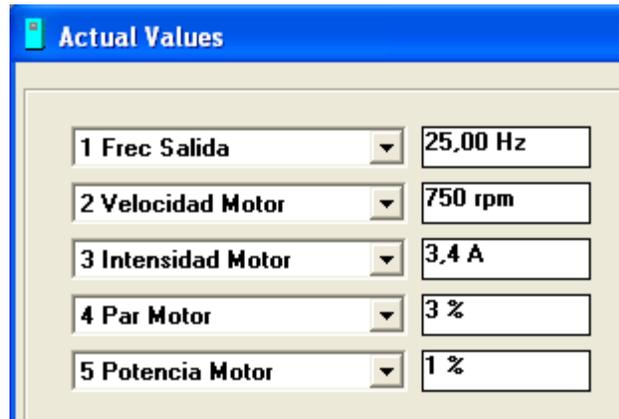
Figura 3-16. Valores actuales del motor a 25Hz.
