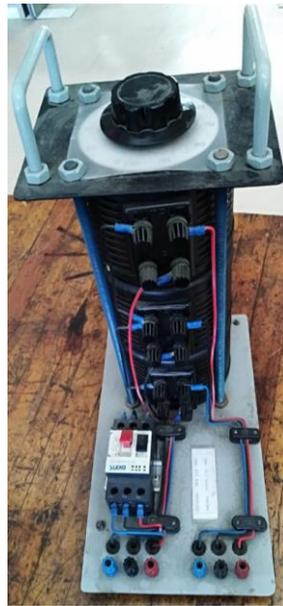
Figura 2-7. Fuente variable alterna trifásica
