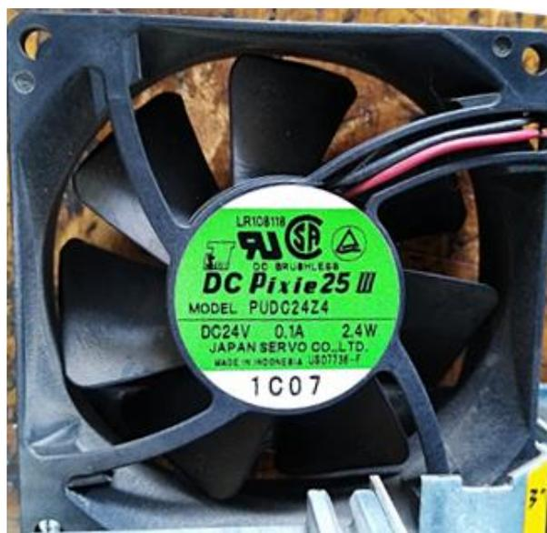
Figura 2-10. Ventilador de dos hilos.
