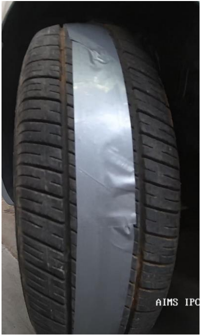
Figura 18. Simulación de falla: Exceso de aire.
