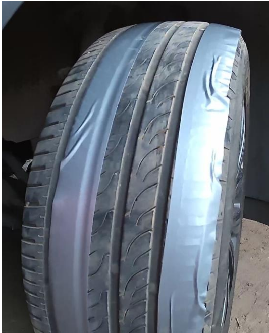
Figura 19. Simulación de falla: Mal alineado.
