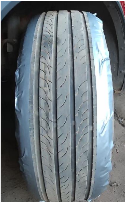
Figura 20. Simulación de falla: Poco aire.
