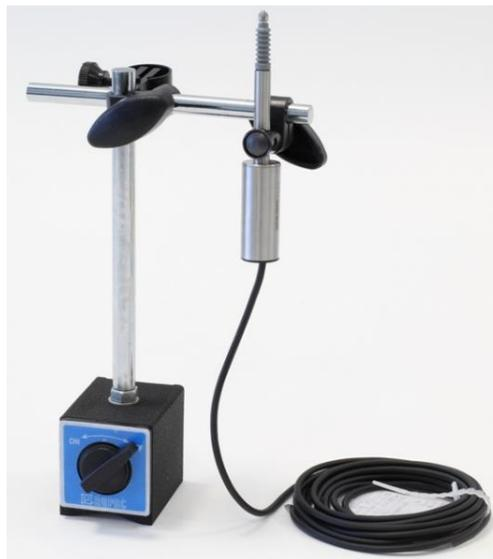
Figura 12- Transductor lineal con soporte
