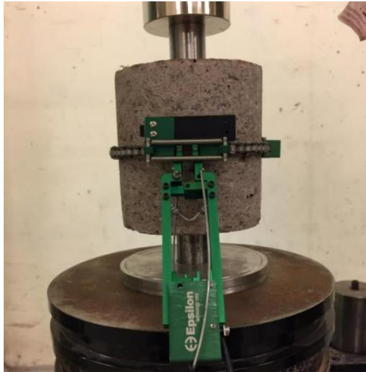
Figura 13- Cadena Extensometrica montada en cilindro de 100 mm
