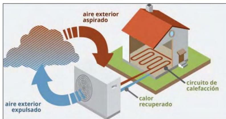
Figura 2.1 Esquema de funcionamiento de aerotermia en una vivienda.
