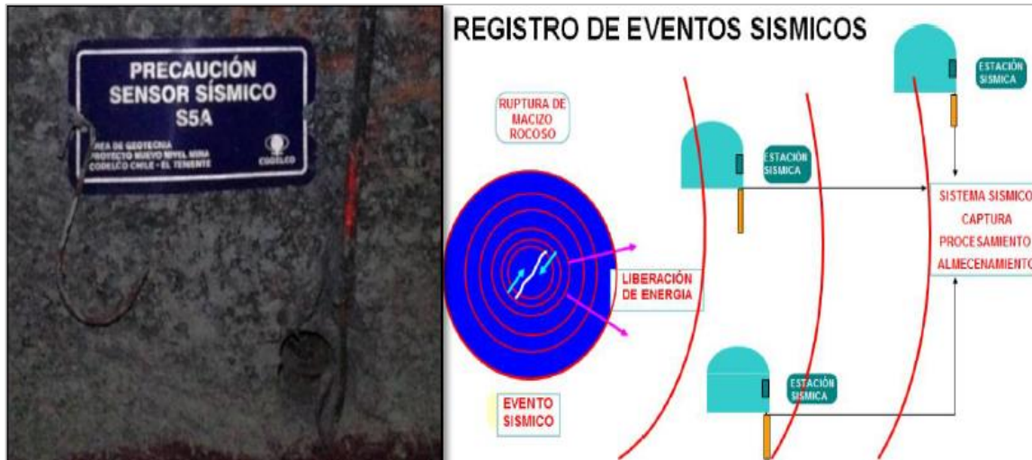
Figura B.3. Sensor Sismico y esquema de registro de eventos de la DET. Fuente: Pozo, 2016 (21).
