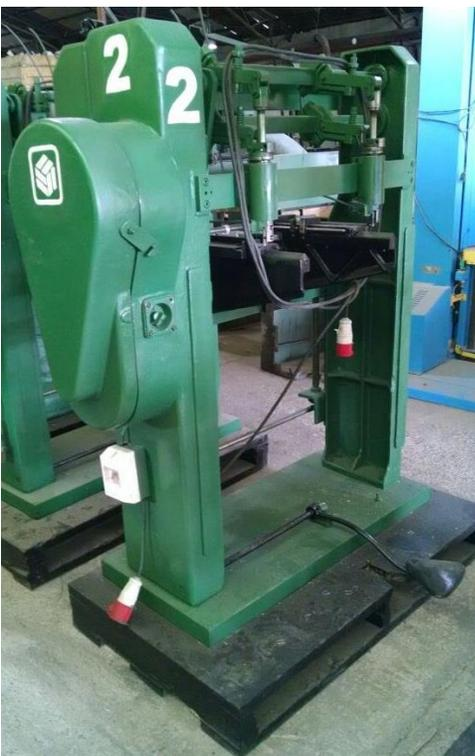
Figura IV-6 Maquina Armadora de Marcos M-75
