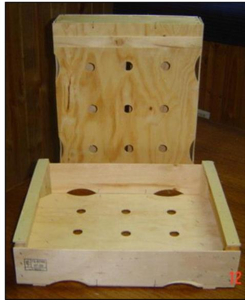
Figura III-9: Caja 400x500 Cabezal con barrote - Fondo Terciado con barrote [11]
