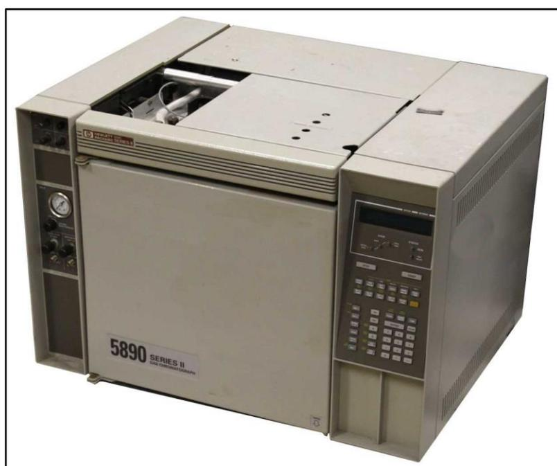
Figura 9: Cromatógrafo de gases
