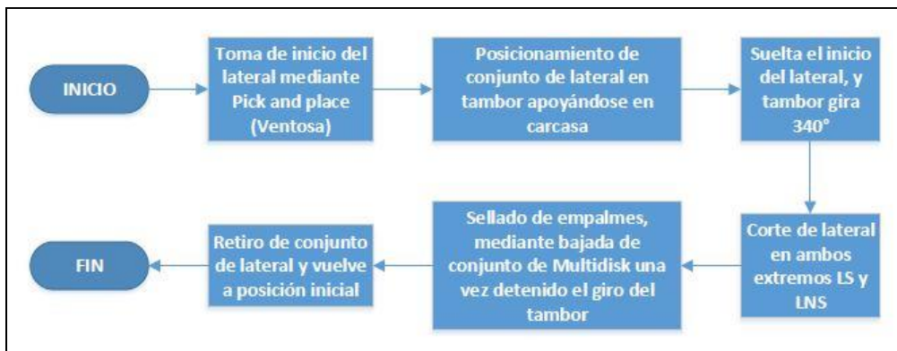
Figura 22. Diagrama de flujo de la aplicación del lateral.
