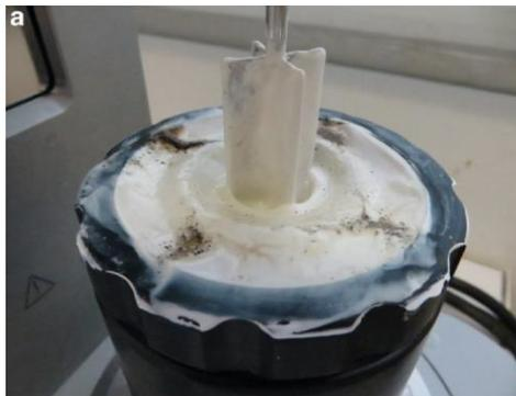
**Figura 30 – Sensor Vane en experimento de Pierre & Perrot (2017).**
