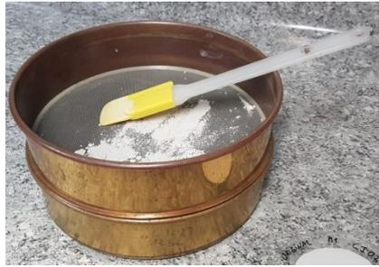
**Figura 49 - Disgregado de muestra en Tamiz #40.**
