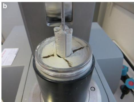
**Figura 31 – Sensor Vane en experimento de Pierre & Perrot (2017).**
