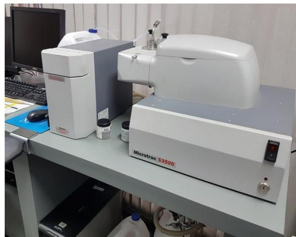
**Figura 53 - Sistema de granulometría laser**
