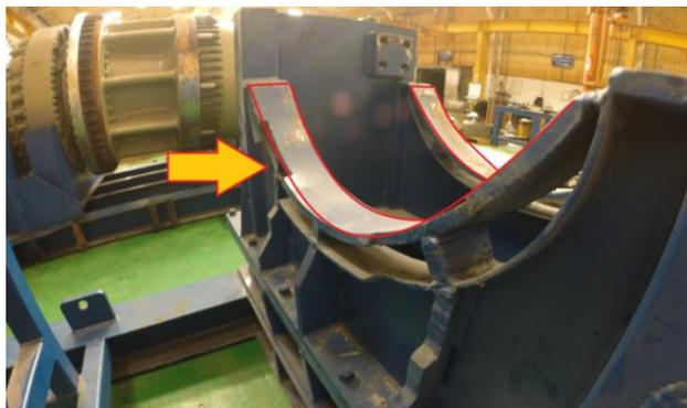
**Figura 3.3: Zona de apoyo vertical del alternador. Fotografía tomada en taller KRCC Santiago.**
