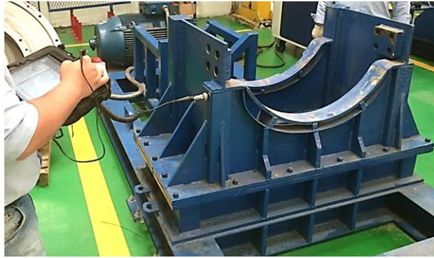
**Figura 4.2:** Ensayo de impacto realizado por el LEC en la estructura del banco de pruebas KRCC Santiago.
