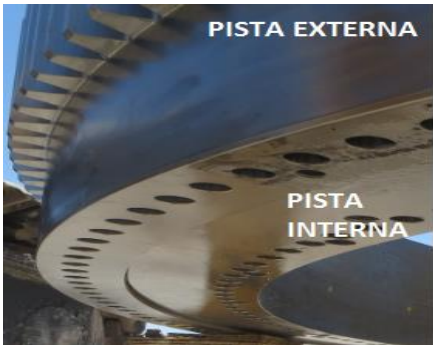
Fuente: Instructivo cambio de corona, palas Komatsu.
