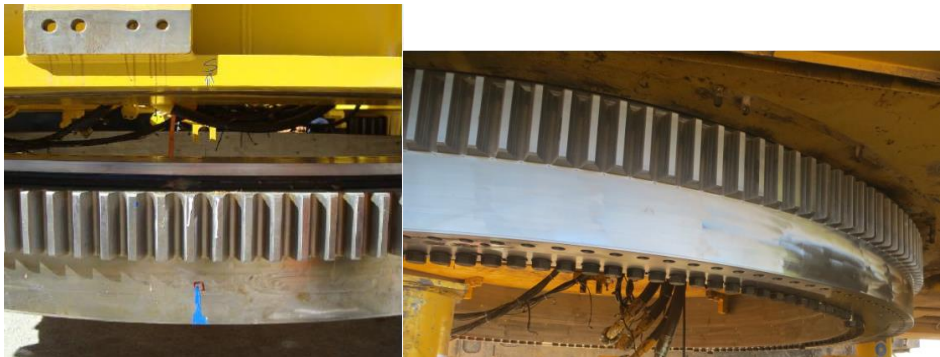
Fuente: Instructivo cambio de corona, palas Komatsu.
