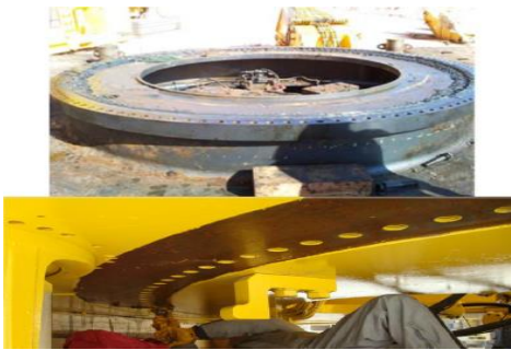
Fuente: Instructivo cambio de corona, Pala Komatsu
