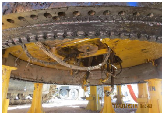
Fuente: Instructivo cambio de corona, palas Komatsu.
