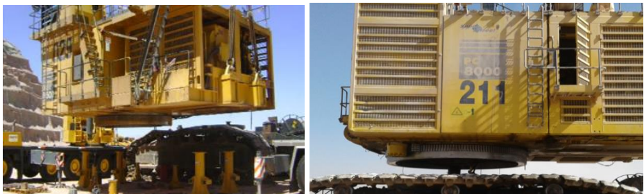
Fuente: Instructivo cambio de corona, palas Komatsu.
