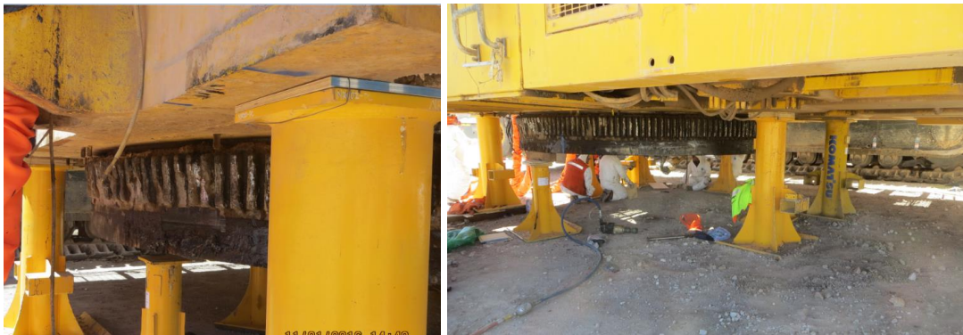
Fuente: Instructivo cambio de corona, palas Komatsu.
