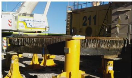
Fuente: Instructivo cambio de corona, palas Komatsu.
