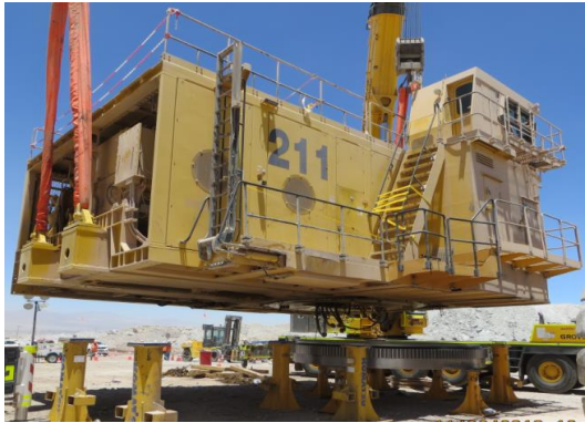
Fuente: Instructivo cambio de corona, palas Komatsu.
