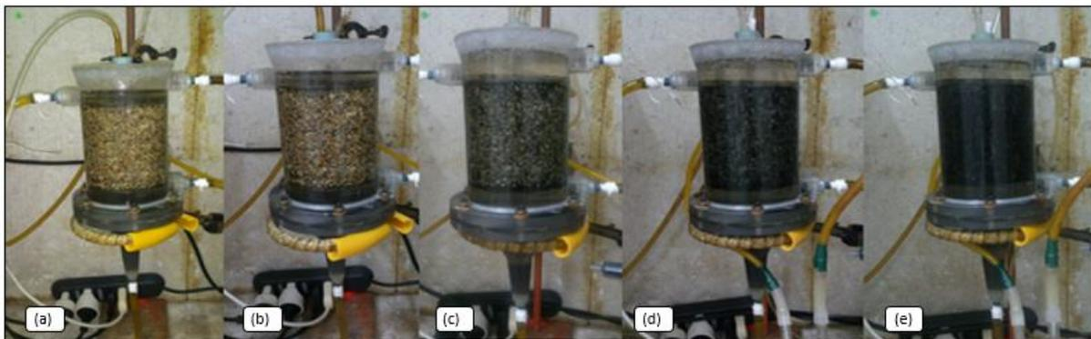
**Figura IV- 1** Proceso de formación de la biopelícula: Enriquecimiento del reactor UAF en operación *fed batch*, inóculo (a): día 1-5, acondicionamiento de la superficie (b): día 6-11, adherencia a la superficie (c): día 11-16, maduración de la biopelícula (d): día 17-24, desprendimiento de las bacterias en el relleno (e): día 25-35.
