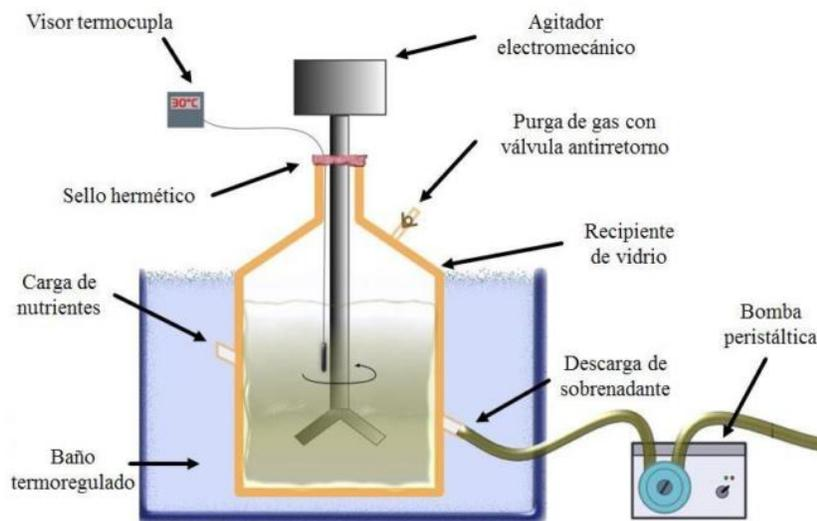
Figura III- 1 Esquema del Reactor de enriquecimiento heterótrofo
