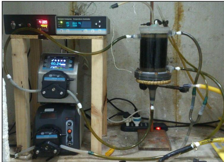
Figura III- 4 Configuración de los materiales en el reactor UAF
