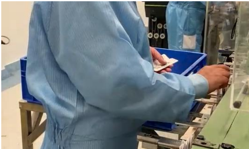
Figura 4. Operador de producción posicionando blíster en el interior de estuche, en línea de producción
