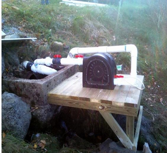
**Figura A.6:** Ejemplo de fijación de la base de la turbina
