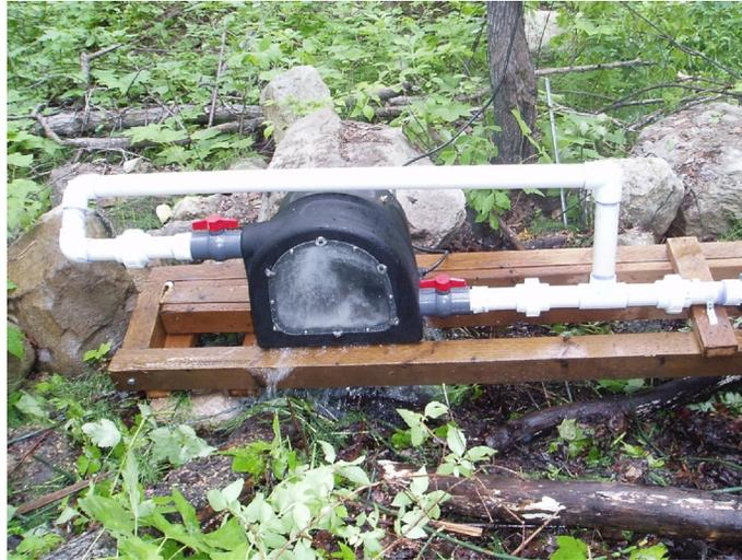
**Figura 4.4:** Ejemplo turbina Pelton Powerspout de dos inyectores
