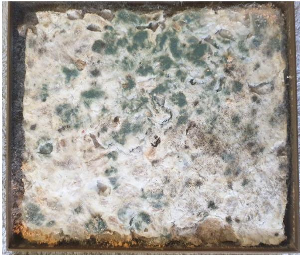
Figura 6 - 1ra Plancha MBF contaminada. (Elaboración propia)
