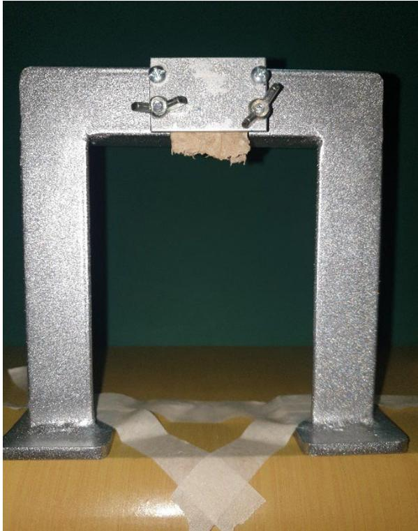
*Figura 32 - Maquina tracción, luego del primer ensayo*
