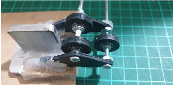
Figura 26 - Detalle ruedas para el riel
