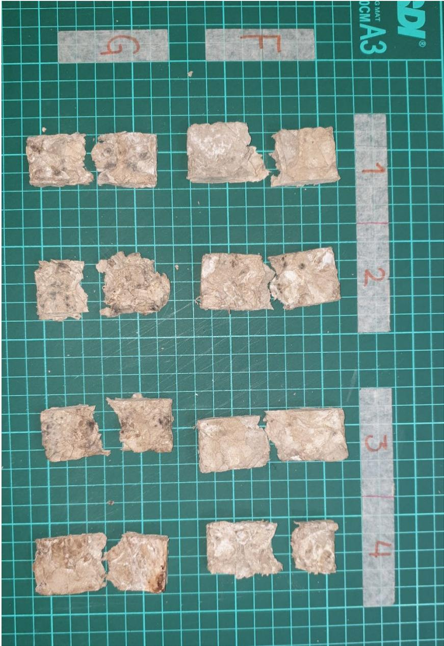
Fotos probetas Experiencia 2 - Rep 2 - Post ensayo de Deformación por compresión
