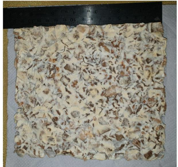
*Figura 5 - 1ra Plancha de MBF – Primer intento de desactivación en horno de cocina eléctrico. (Elaboración propia)*
