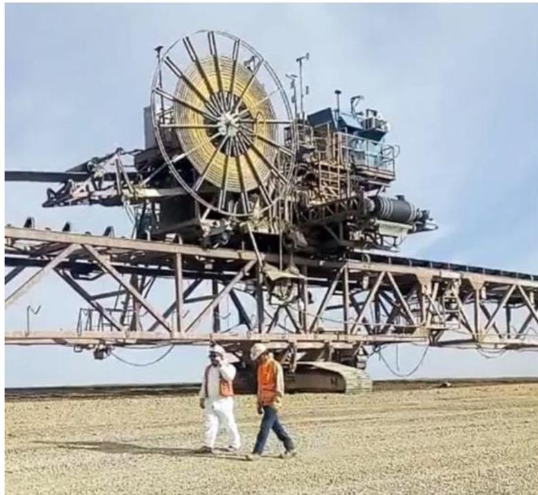
Figura 5.4. Apilamiento en pila dinámica Tripper 201
