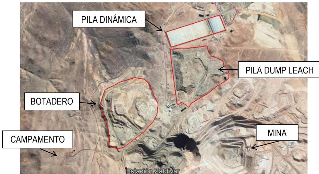
Figura 3.4. Pilas Dinámica, Dump Leach y Botadero
