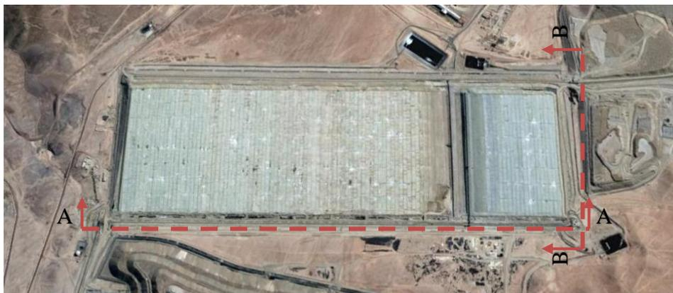
Figura 5.24. Pila dinámica o HL y vistas A-A y B-B
