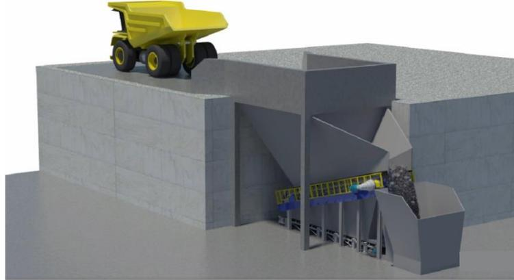
Figura 3.5. *Apron Feeder* y tolva alimentación chancado primario
