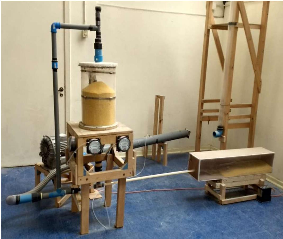
**Figura 5-10: Vista general del sistema neumático para modelar el llenado de contenedor a escala.**
