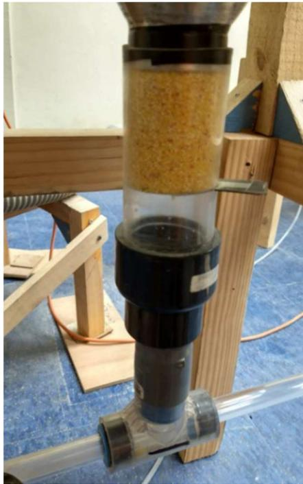
**Figura 5-6: Unión tolva – “T” de alimentación y válvula de guillotina.**
