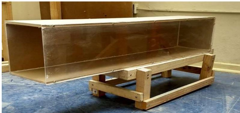
**Figura 5-9: Modelo de contenedor construido en escala 1:12.**
