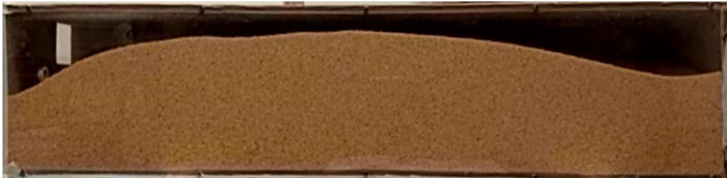
**Figura 6-4: Llenado de contenedor,  $h=130$  [mm],  $V_0=20,0$  [m/s] e inclinación de  $0^\circ$ .**
