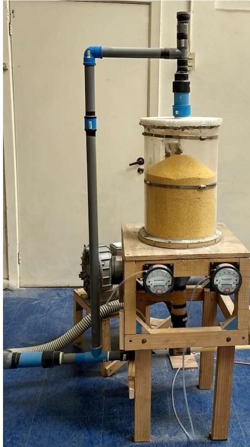
**Figura 5-5: Silo de alimentación con línea de alimentación de aire instalada.**
