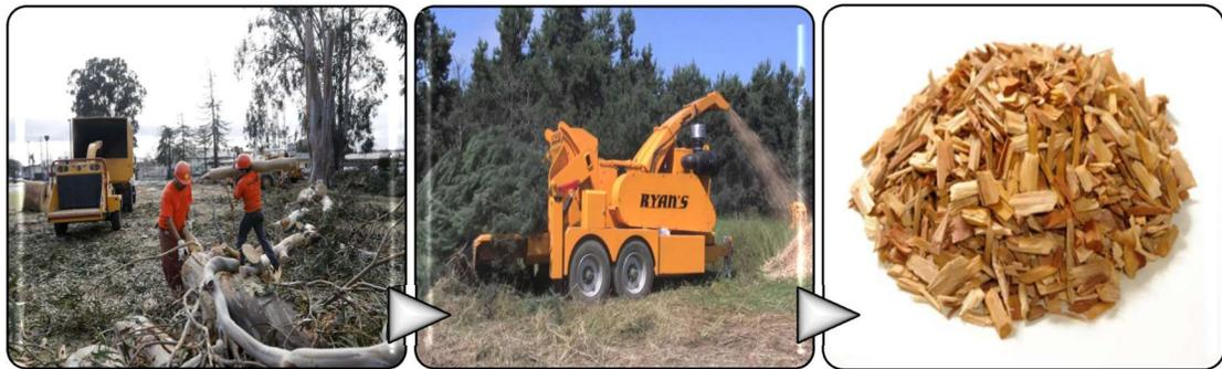
**Figura 1-1: Proceso de generación de astillas en terreno [1].**
