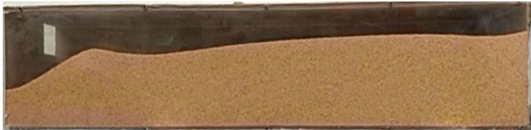
**Figura 6-6: Llenado de contenedor, h=80 [mm], V<sub>0</sub>=25,8 [m/s] e inclinación de 0°.**
