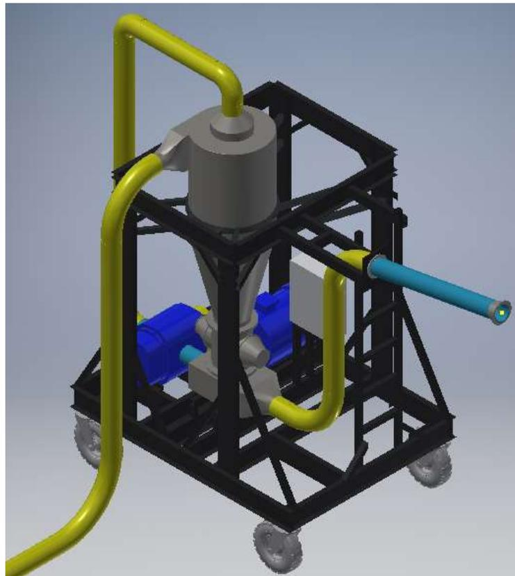
Figura 7-4: Vistas principales y 3D del sistema diseñado para el llenado de contenedores.
