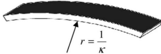
Figura 42: definición del parámetro de curvatura en un recubrimiento depositado por rociado térmico [68].
