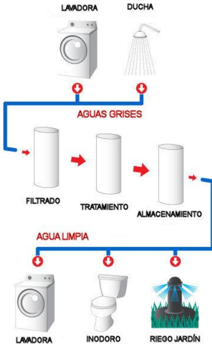
Es importante destacar que a este sistema se debe incorporar la captación de aguas lluvias, las cuales estarán incluidas en el mismo sistema de filtrado que las aguas grises.
