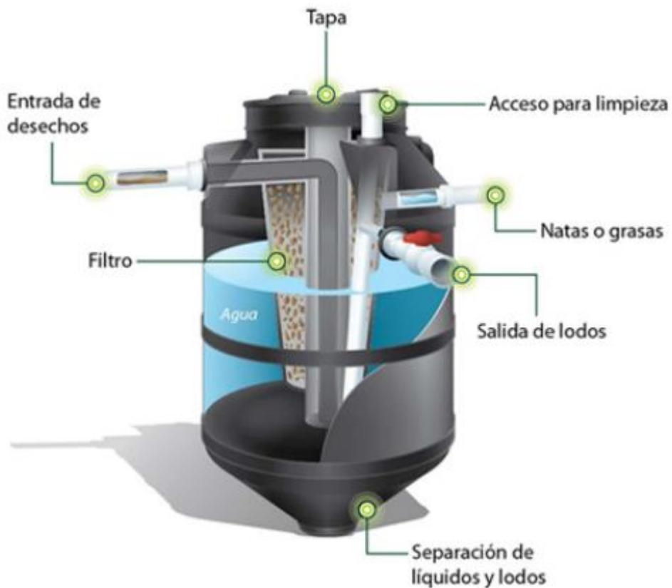
Las aguas negras, se introducen al biodigestor autolimpiable por la conexión al desagüe y se dirigen al fondo del tanque, área de lodos. En esta área de lodos se va a formar una colonia de bacterias anaeróbicas, que se alimentan de las excretas, produciendo así el proceso séptico.
