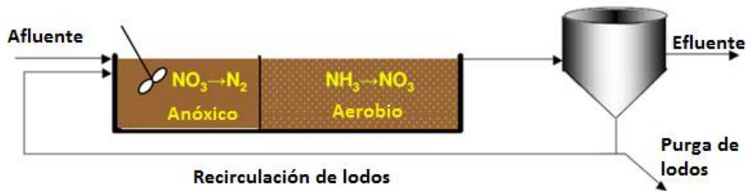
Figura 9. Configuración de pre-desnitrificación (Adaptado de: Liu y Lipták, 1999)
