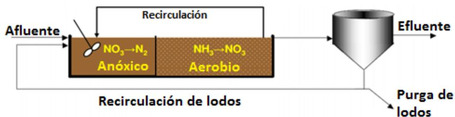
Figura 10. Proceso de Ludzack-Ettinger modificado para obtener mayores tasas de remoción de nitrógeno, (Adaptado de: Liu y Lipták, 1999)
