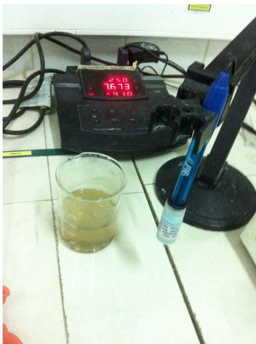
*Figura 44. Estación de medición de pH con instrumentos necesarios*
