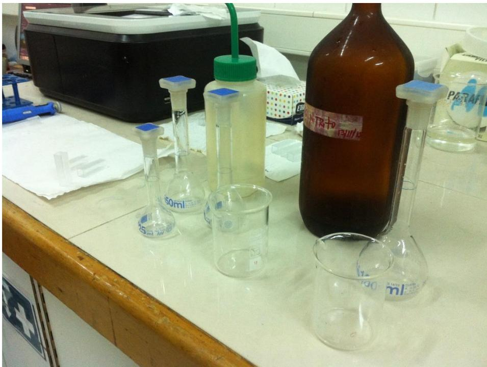
Figura 39. Puesto de medición de nitrito con sus materiales y reactivos
