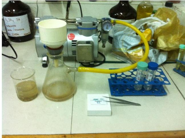
*Figura 41. Estación de filtrado con materiales necesarios*
